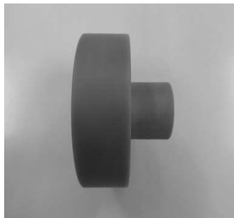
写真 2-5-3(1) 傷防護治具の一例
