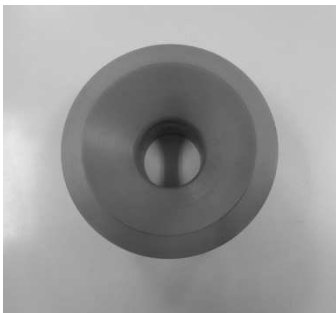
写真 2-5-3(1) 傷防護治具の一例
