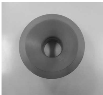
写真 4-6-2 (1) 傷防護治具の一例
