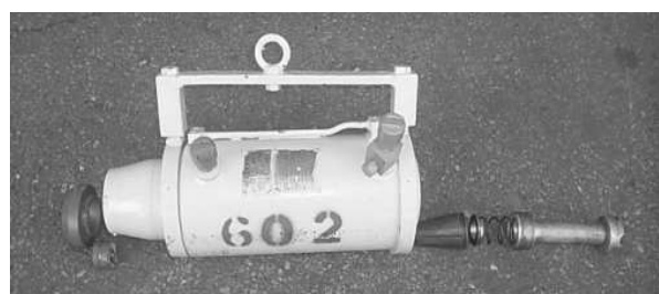
写真 4-1-9(2) 内蔵型ジャッキ分解状況
