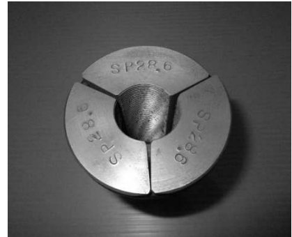
SUPRO ストランド緊張ウェッジ (SP+ワイヤ線径を刻印)
