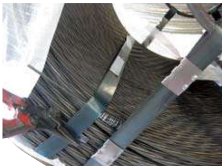
最後の帯鉄の切断状態
